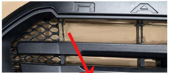
Der Steg auf der linken Seiten muss für die Kabelführung auf 10 mm gekürzt werden.
