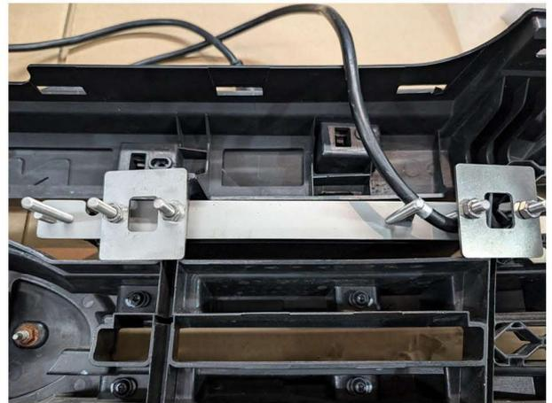
Setzen Sie auf das Gewinde jeweils eine Unterlegescheibe, dann die Muttern und ziehen Sie dann diese mit einem Schraubenschlüssel fest. Achten Sie darauf, dass die Halterung nicht verrutscht.
